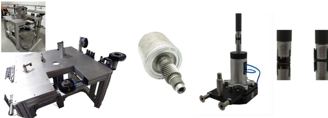
Abbildung 8: Austreibetisch mit Hub- und Vibrationseinheit (links) zur Entnahme von Rotor (mittig) und Stator. Rechts: Führungs- und Greifwerkzeug für den Rotor, Verriegelungseinheit geschlossen und geöffnet (rechts außen).
