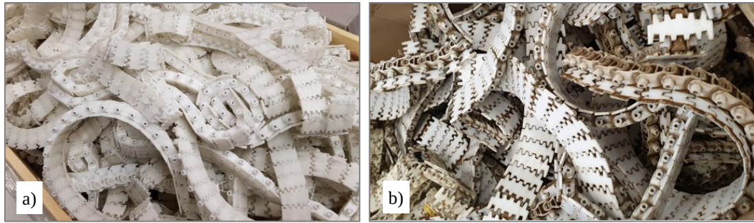
Abbildung 3: Förderketten nach mehrjähriger Anwendung in a) einem Pharmaunternehmen sowie b) einer Kaffeerösterei (rechts)
