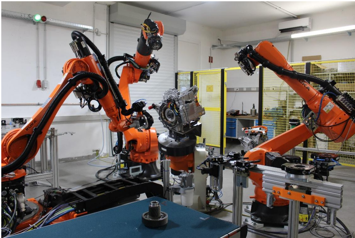
Abbildung 1: Technikum zur zerstörungsfreien automatisierten Demontage am CUTEC Forschungszentrum.
