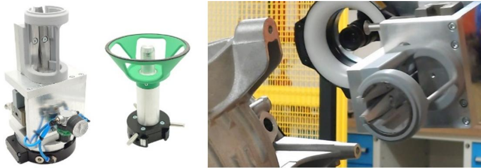
Abbildung 5: Werkzeug zum Lösen und Entfernen des Sicherungsrings (links), Hilfswerkzeug zum Drehen des Rotors (mittig) und Sicherungsring im Werkzeug (rechts).
