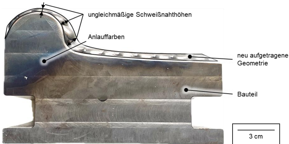
Abbildung 4. Demonstratorbauteil mit einem Auftrag von zwei Lagen; Bild: Siemens
