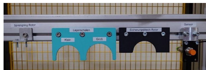
Abbildung 12: Sensorunterstütztes Abstreifsystem zur Bauteilablage
