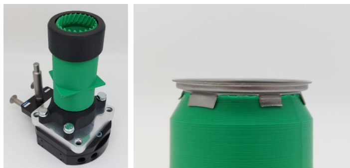
Abbildung 3: Werkzeug zum Lösen und Entfernen des Sicherungsbleches (links), Vorgang des Aufbiegens der Laschen durch das Werkzeug, dargestellt ohne äußeren Mitnehmer (rechts).
