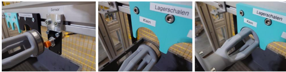
Abbildung 13: Abstreifprozess für die magnetisch gehaltene Lagerschale der Zwischenwelle inkl. Einstellscheibe
